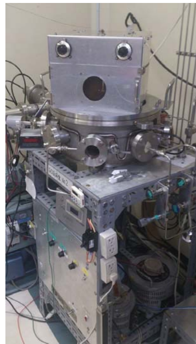
図.1 a-Ge 膜の堆積に使用した PECVD 装置
